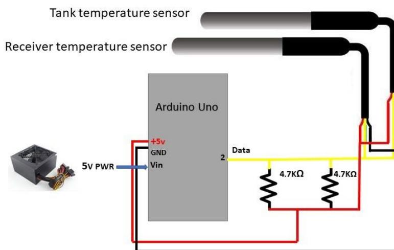
Figure 8: Temperature sensor (DS1820) wiring diagram
